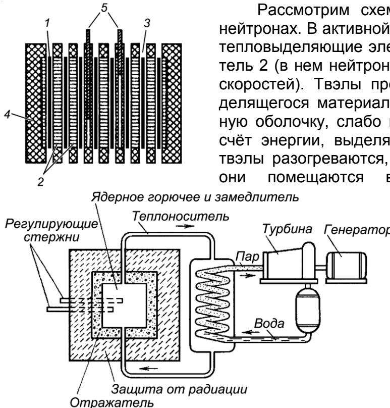
Рассмотрим схему реактора на медленных нейтронах. В активной зоне реактора расположены тепловыделяющие элементы (твэлы) 1 и замедлитель 2 (в нем нейтроны замедляются до тепловых скоростей). Твэлы представляют собой блоки из делящегося материала, заключённые в герметичную оболочку, слабо поглощающую нейтроны. За счёт энергии, выделяющейся при делении ядер, твэлы разогреваются, а поэтому для охлаждения они помещаются в поток теплоносителя 3.
