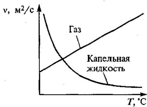
Рис. Зависимость вязкости от температуры
