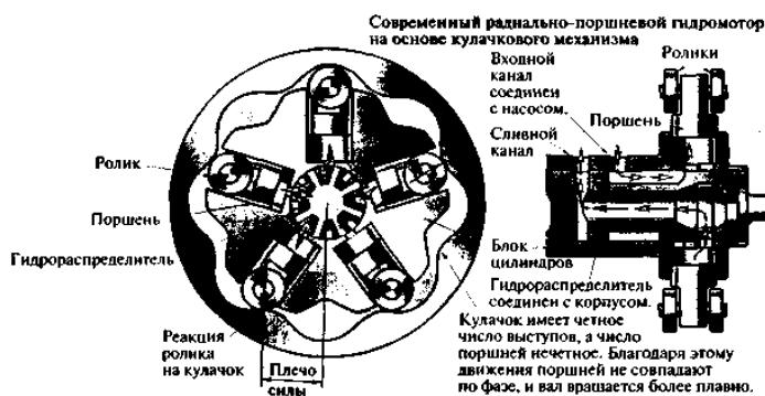
Их конструкции принципиально не отличаются от конструкций одноименных роторных насосов.
