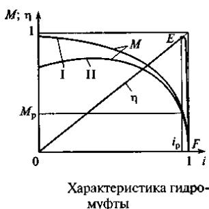
Из графиков  $M = f(i)$  на рис. следует, что при малых  $i$  передаваемые моменты значительны, причем зависимость  $M = f(i)$  может иметь максимум (линия II на рис.) или не иметь его (линия I). При больших передаточных отношениях  $i$  передаваемый момент  $M$  уменьшается, а при  $i \rightarrow 1$  резко падает до нуля.
